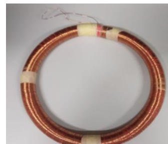
Fig. 6 Bobina de Rogowski confeccionada para monitoramento da corrente de fuga.
