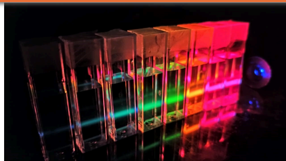
Figura com QDs de CdTe de diferentes tamanhos, luminescendo pela excitação de um laser UV (imagem: Pedro Felipe Garcia Martins da Costa)
