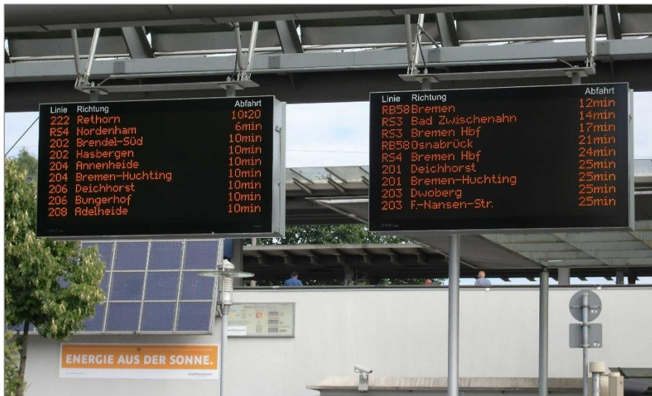
Abb. C-12: Gutes Beispiel: Der DFI-Anzeiger am Bahnhofsvorplatz bzw. ZOB Delmenhorst informiert über die nächsten abfahrenden Bahnen und Busse. (Foto ZVBN)
