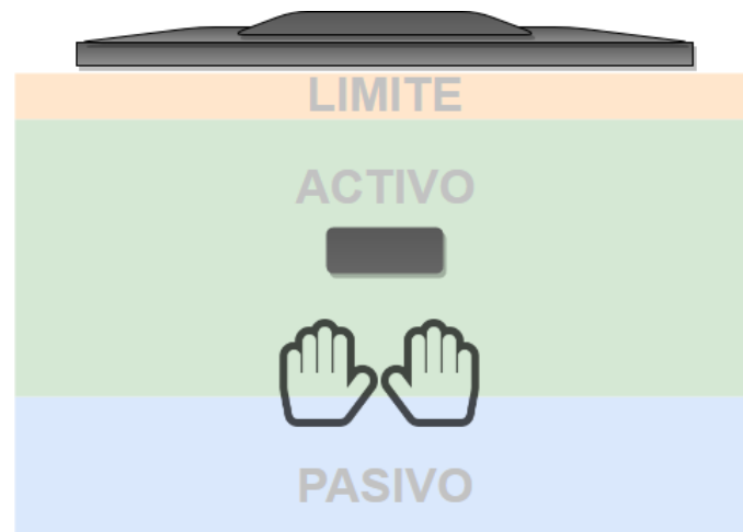
Fig. 4. Representación de las áreas de interacción con respecto a la profundidad entre el usuario y el LMC.
