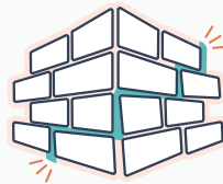
AGRIETAMIENTO EN LAS ESQUINAS
