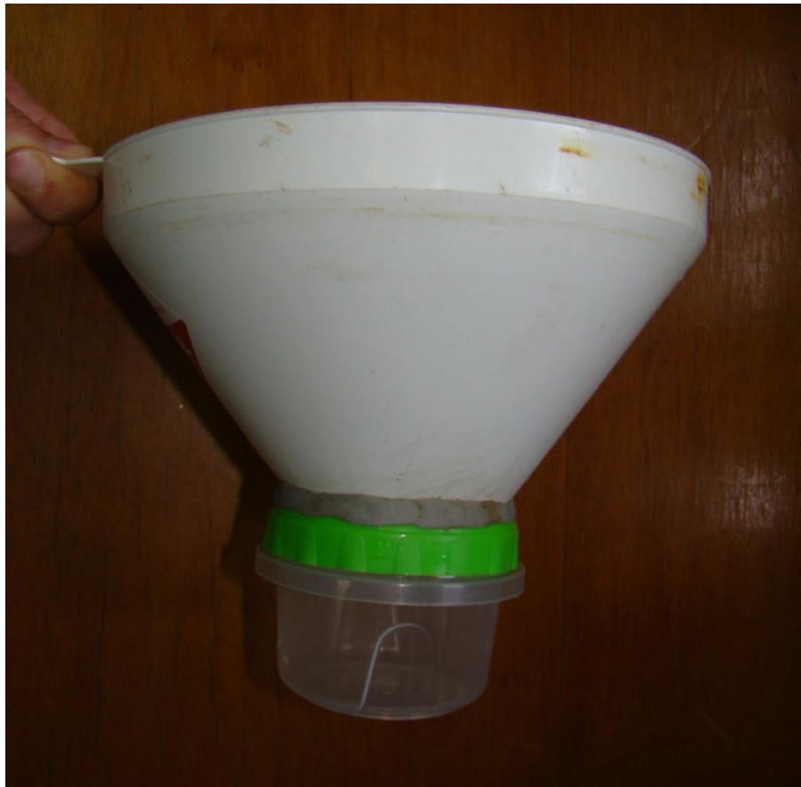
Funil com o pote coletor. Colocamos araldite entre o funil e a tampa p/ evitar entrada de água da chuva.
