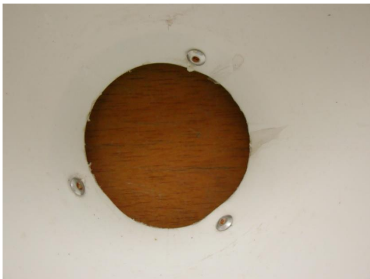
Detalhe dos rebites visto pela parte de dentro do funil.
