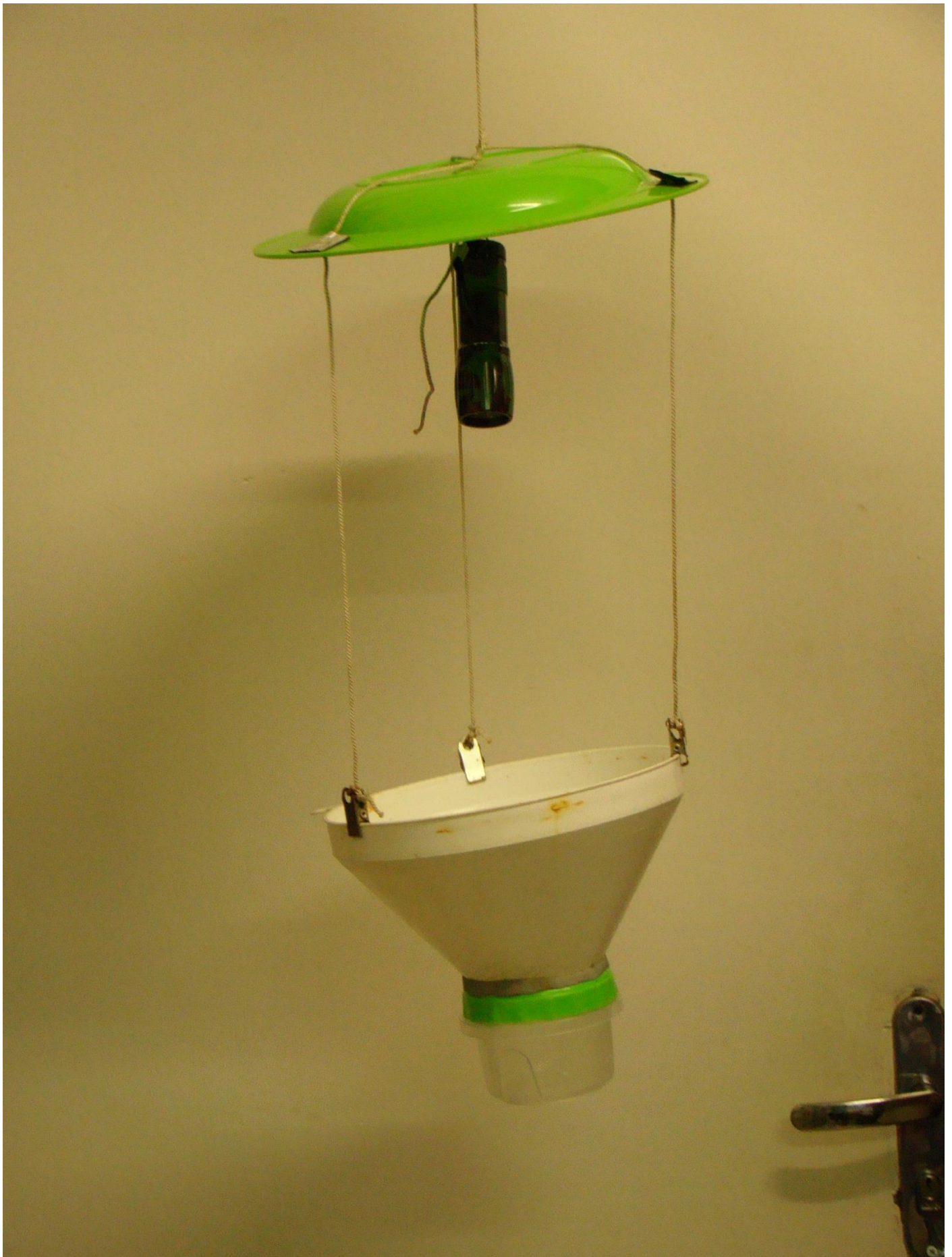
Imagem do coletor montado com a lanterna de led. A lanterna precisa ficar apontada p/ o funil. Assim ela atrai os insetos p/ o coletor.
