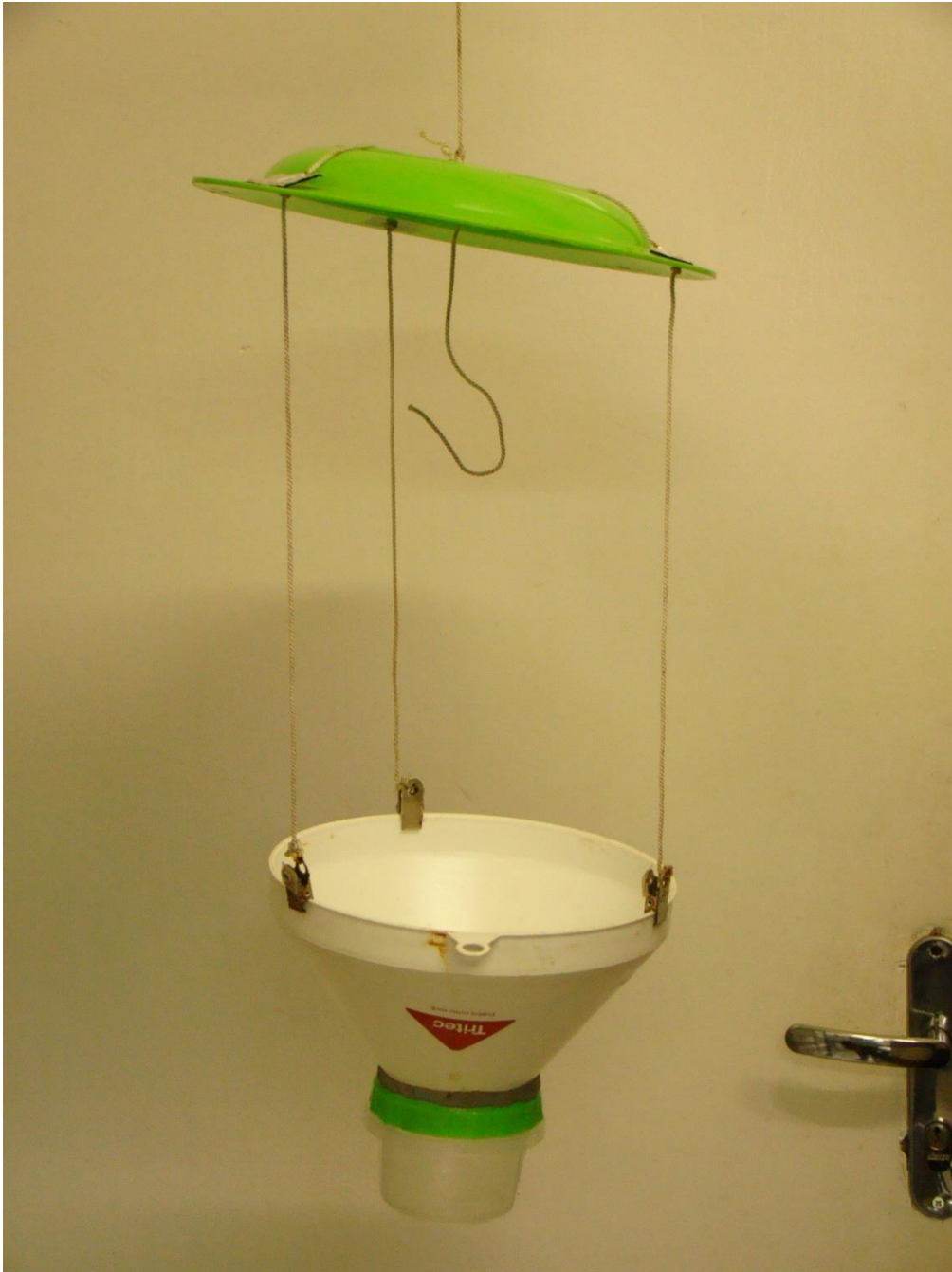
Vista da armadilha luminosa montada. Detalhe nos cliques e da corda de nylon solta para amarrar a lanterna de led.
