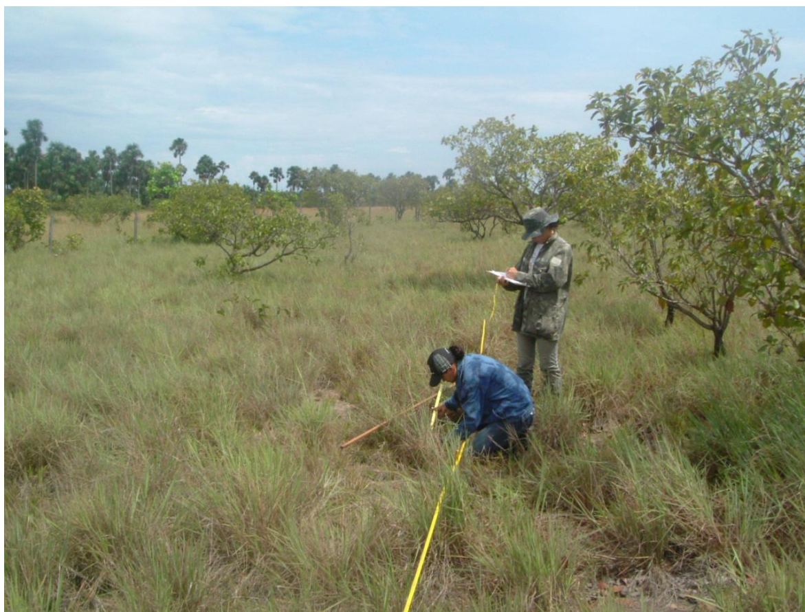
Figura 4 – Marcação da parcela através de uma linha base que segue os piquetes de ferro distanciados a cada 10m (sub-parcelas).
