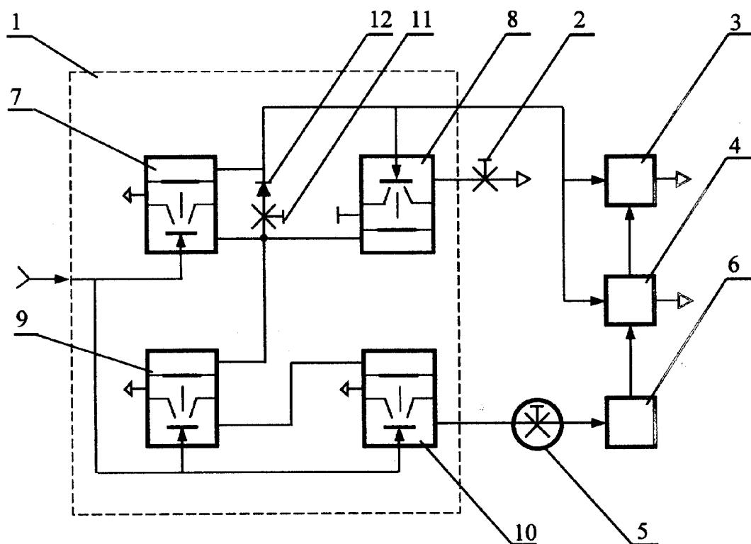
1 - пневматический интегральный модуль; 2, 11 - пневмосопротивление;
