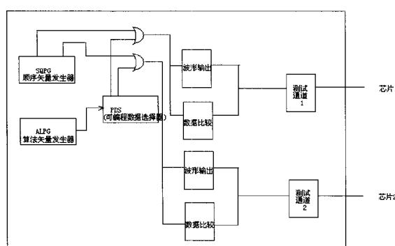
1. 一种测试仪同测方法,其特征在于:第一步:首先,需要对错误处理程序进行修改,设定多个芯片同测作为一个芯片进行测试,所有同测芯片的管脚不超过测试仪总的测试通道数;第二步:算法矢量发生器,对测试向量中需要由算法矢量发生器所产生的测试通道,将算法矢量发生器产生的一个信号通过可编程数据选择器分配到多个芯片的测试通道;第三步:顺序矢量发生器,对测试向量中需要由顺序矢量发生器所产生的测试通道,通过设定程序将原来一个芯片的测试向量扩展到多个芯片的测试通道;第四步:获得所有测试通道的测试结果,所述测试通道根据不同通道地址进行分组,根据所述通道分组的结果判断各个芯片合格与否。
