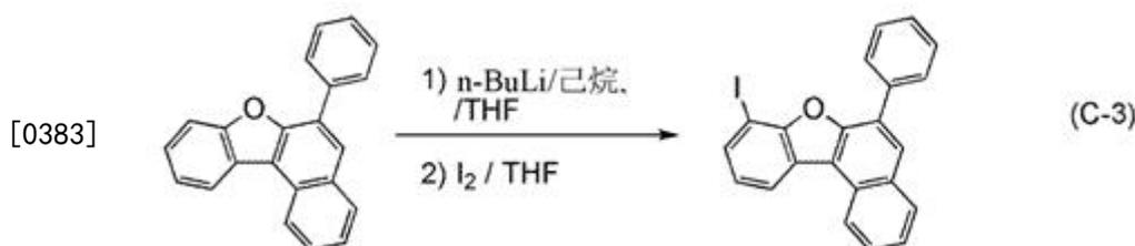
[0384] 将4.9g(17mmol)的6-苯基苯并[b]萘并[1,2-d]呋喃放在300mL三口烧瓶中,对烧瓶内进行氮气置换,然后添加87mL的THF。在将该溶液冷却到-75℃之后,将11mL(18mmol)的正丁基锂(1.59mol/L 正己烷溶液)滴下到该溶液中。在滴下之后,在室温下搅拌所得到的溶液1小时。搅拌之后,将该溶液冷却到-75℃,然后将其中碘4.6g(18mmol)溶解于18mL的THF中而成的溶液滴下到上述溶液中。在将温度回升至室温的同时搅拌所得到的溶液17小时。搅拌之后,对该混合物添加硫代硫酸钠水溶液,搅拌1小时,然后使用水对该混合物的有
