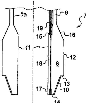
1. 钻具 (1) 的管状组成件, 其用于钻探出一井孔, 钻探流体围绕所述管状组成件 (7) 且按从钻井底到地面的方向循行, 所述管状组成件 (7) 具有第一端部、第二端部 (8)、以及基本上呈管状的中央区域 (9), 所述第一端部具有阴螺纹, 所述第二端部具有阳螺纹, 所述管状组成件 (7) 具有一通信用管 (19), 所述通信用管 (19) 至少布置在中央区域 (9), 且与所述中央区域的一孔腔进行接触, 一信号传输电缆 (18) 布置在所述通信用管 (19) 中,
