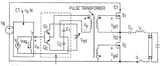
ONE IMPLEMENTATION OF VOLTAGE-CONTROLLED VOLTAGE SOURCE REQUIRED
