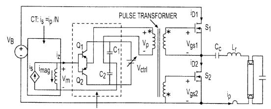
ONE IMPLEMENTATION OF VOLTAGE-CONTROLLED VOLTAGE SOURCE REQUIRED
