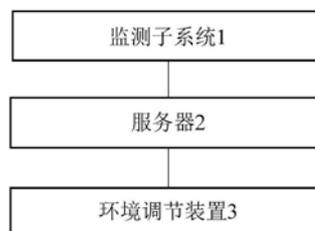
1. 医疗器械储存环境实时监测系统,其特征是,包括监测子系统、服务器、环境调节装置;所述监测子系统包括汇聚节点和多个部署于医疗器械储存区域内的传感器节点,传感器节点采集所监测位置的环境数据,并发送至汇聚节点;所述汇聚节点与所述服务器通信连接,以将接收的环境数据发送至该服务器;所述服务器对环境数据进行分析处理,在环境数据超出预设指标阈值时生成相应的控制指令,并根据控制指令控制环境调节装置的运行,以调节医疗器械储存区域内的环境。
