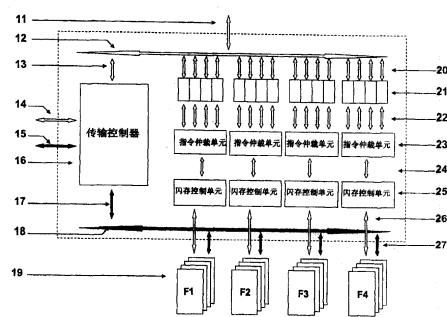
1. 一种并行闪存控制器，用于控制多个闪存通道的闪存芯片组，其特征在于，闪存控制器包括：传输控制器、多个闪存控制单元、多个指令仲裁单元、多个指令队列单元；每个闪存通道的闪存芯片组分别对应一个闪存控制单元、一个指令仲裁单元以及一个指令队列单元；传输控制器通过片内数据总线与各闪存芯片进行数据交互；闪存通道内的闪存芯片划分成多个闪存行；闪存控制指令按通道并行下发到指令队列单元，指令队列单元解析并存储对应闪存通道的闪存控制指令；各通道对应的指令仲裁单元根据设定的仲裁规则对该通道的多个行的闪存控制指令进行仲裁判断，确定各闪存控制指令的发送顺序；闪存控制单元接收指令仲裁单元下发的闪存控制指令，对通道内的闪存行按行进行分时复用方式的读写控制。
