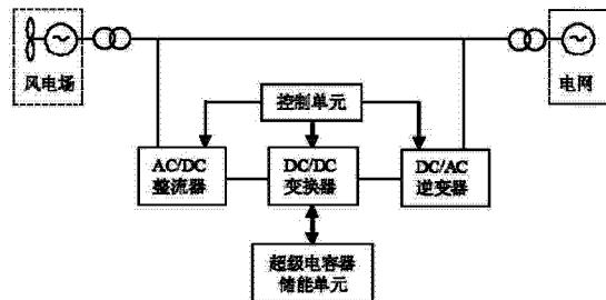
1. 一种基于灰色模型控制的风力发电储能装置,建立在风电场与电网之间,其特征在于:该储能装置主要由控制单元、AC/DC 整流器、DC/AC 逆变器、双向 DC/DC 变换器及储能用的超级电容器储能单元构成;控制单元分别连接 AC/DC 整流器、DC/AC 逆变器和双向 DC/DC 变换器,AC/DC 整流器与 DC/AC 逆变器之间连接有双向 DC/DC 变换器,双向 DC/DC 变换器与超级电容器储能单元(1)相连接。
