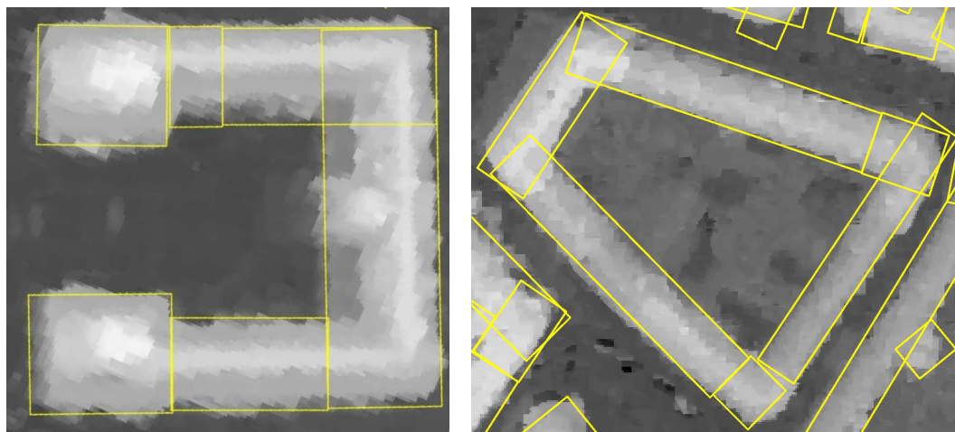
FIG. 2.6 – Résultats d'extraction de bâtiments par agencement de rectangles.
