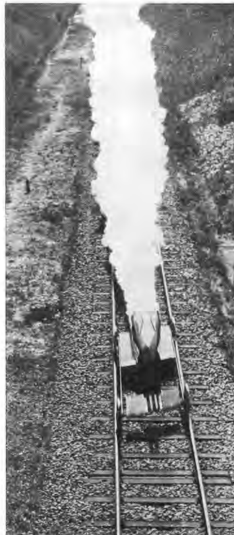
Versuch mit einem Opel-Raketenwagen auf Schienen in der Nähe von Hannover am 23. Juni 1928. Der erste Start über die 5 km lange Versuchsstrecke, ohne Mitfahrer durch elektrische Fernzündung durchgeführt, verlief programmgemäß. Der Wagen erreichte eine Geschwindigkeit von 281 km/h.
