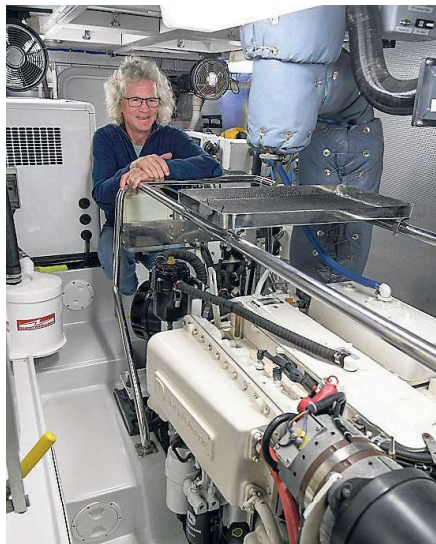
Båten drivs av en 265hp John Deere PowerTech 6068AFM. James Hamilton är gammal racerbilsmechaniker och håller maskinrummet skinande rent.
