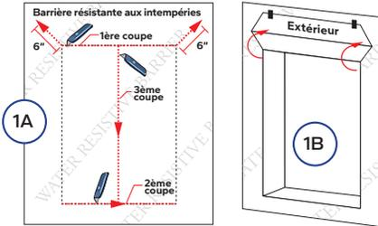
**Remarque:** Un motif de découpe en forme de carré est également acceptable, à condition que du ruban d'étanchéité soit utilisé de chaque côté, collé à 2,54 cm sur la barrière contre les intempéries et enroulé dans l'ouverture.
