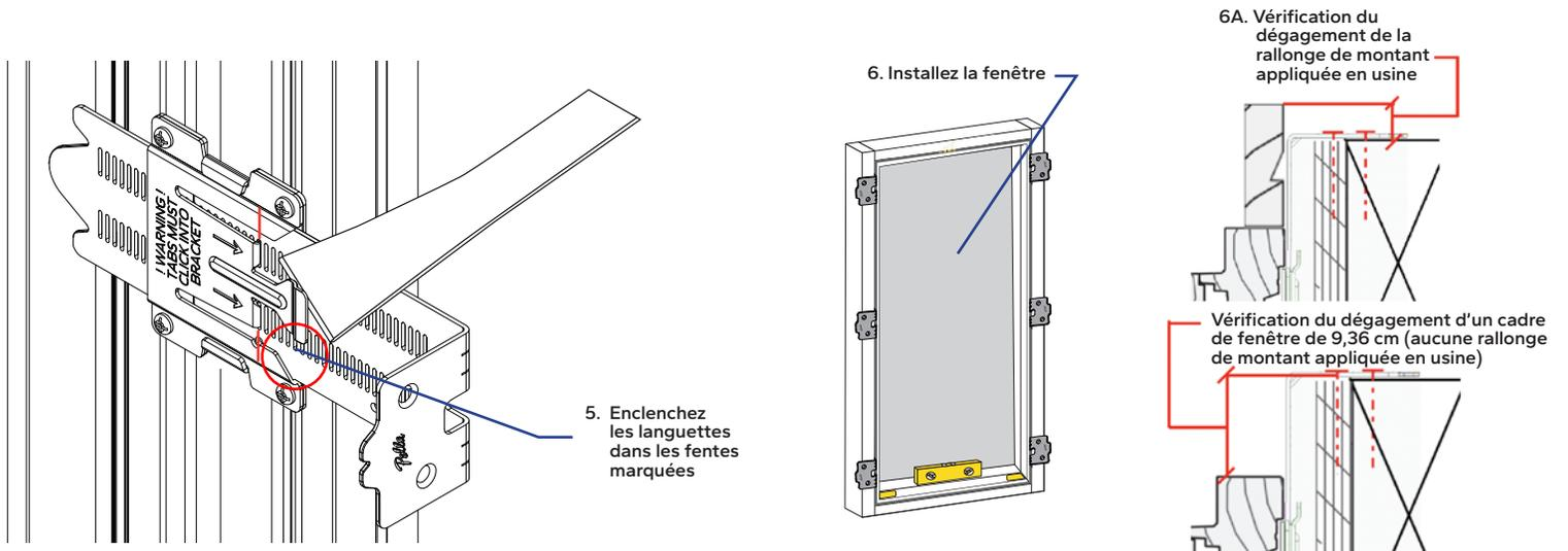
7. **Si la fente marquée donne l'emplacement souhaité pour la fenêtre dans le système mural, marquez le reste des supports d'ancrage de fenêtre nécessaires et poursuivez les installations de fenêtre supplémentaires.** Dans le cas contraire, alignez la languette du bras de blocage à la bonne fente et marquez de nouveau les supports supplémentaires, au besoin.
