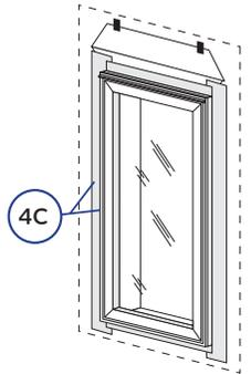
**AVIS** N'APPLIQUEZ PAS de scellant continu sous l'aillette de l'appui. N'APPLIQUEZ PAS de ruban d'étanchéité sur l'aillette d'appui.
