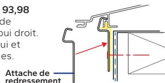
**AVIS** Vérifiez que les ailettes d'étanchéité et les couvre-aillettes ne sont pas endommagés. Ajoutez du ruban d'étanchéité au besoin pour réparer les ailettes ou coins d'aillettes endommagés.
