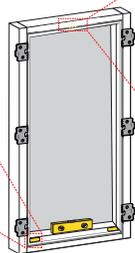
Le stabilisateur de linteau aide à maintenir la fenêtre dans l'ouverture pendant l'installation.
