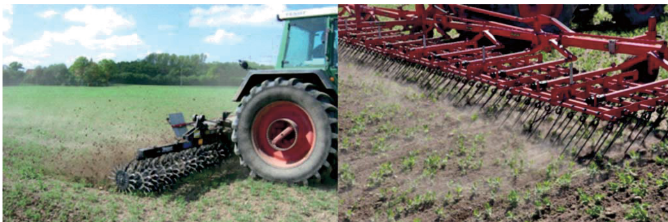
Abb. 6. Möglichkeiten der mechanischen Unkrautbekämpfung in Leguminosen. Links: Einsatz eines Rollstriegels in Blauen Lupinen; rechts: Einsatz eines Hackstriegels in Futtererbsen.
