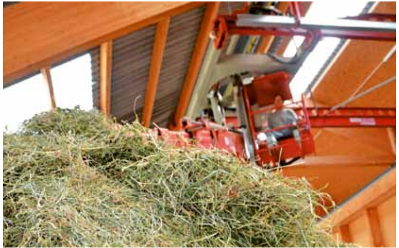
Eine leistungsfähige Heubelüftung trägt in Kombination mit einer Greiferanlage zu einer verlustarmen und qualitätssichernden Heuproduktion bei.
