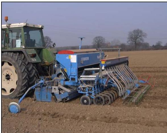
Abb. 6: Drillmaschine (24 Reihen) mit einem Nachsaatkasten mit 12 fixierten Ausläufe für eine Breitsaat vor dem Striegel oder eine Saat in alternierenden Reihen durch Umstecken der Schläuche an die Drillschare, Trenthorst 2003
