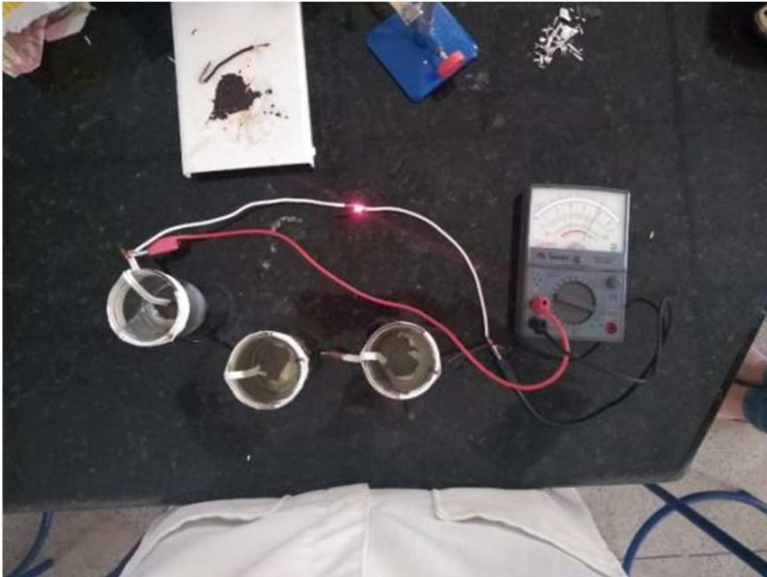
Figura 6: LED aceso após ser conectado a três pilhas ligadas em série
