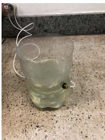
Figura 4: Solução após ser aquecida pelo calor liberado no efeito Joule, mostrando a pigmentação da solução (Dinis Tavares Fialho, 2018)
