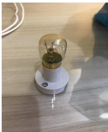
Figura 1: Lâmpada queimada após o curto-circuito (Ana Luísa Moreira Brandão, 2018)
