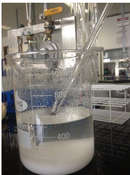
Fig. 3: Precipitado de Sulfato de Zinco em uma mistura água e etanol. (Fonte: Ana Paula Lima, 2015)
