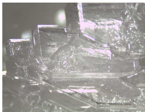
Fig. 4: Cristal de ZnSO_4 , após recristalização, visto em lupa com aumento de 16 vezes. (Fonte: próprio autor, 2016)
