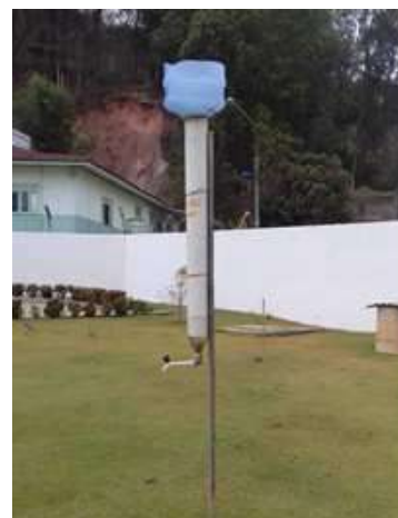
Fig. 2: Pluviômetro de baixo custo instalado no Ifes Campus Ibatiba. (Fonte: autores, 2017).
