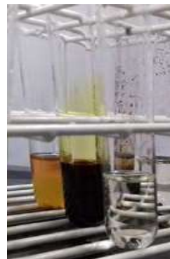
Fig.5: Alterações da coloração provocadas pela adição dos indicadores de polaridade, durante os testes de identificação das fases: água + I_2 , gasolina + I_2 e gasolina + água + I_2 .
