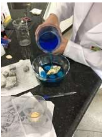
Fig. 6: Solução de \text{CuSO}_4 sendo adicionada no recipiente com o suporte.
