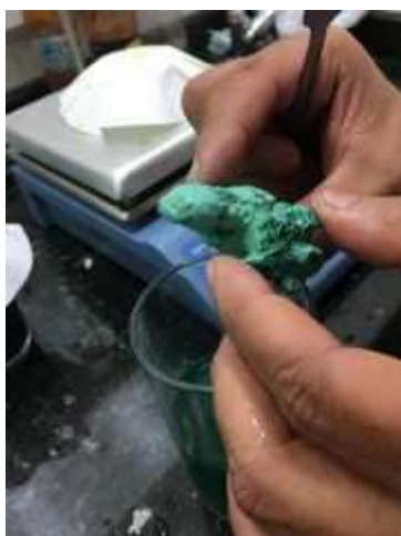
Fig. 10: Suporte corroído pela solução de NaCl e \text{CuSO}_4 .
