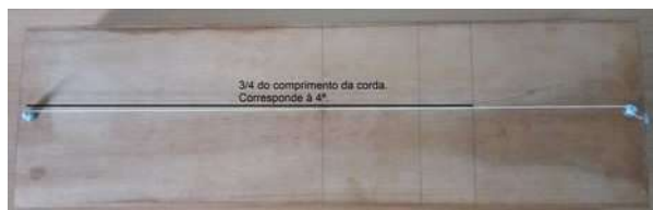
Fig. 2: Comprimento da corda correspondente à 4ª. (Fonte: Vinícius Canal, 2017).
