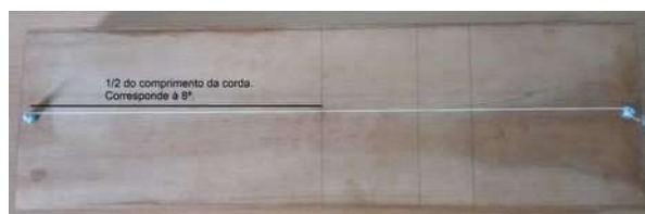
Fig. 2: Comprimento da corda correspondente à 8ª. (Fonte: Vinícius Canal, 2017).
