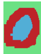
Figure 37.d. Les marqueurs après étiquetage et érosion.
