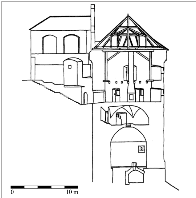
Obr. 9. Pražský hrad, věž Daliborka, řez. Podle Menclová 1972, 2, 383.
