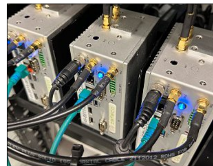
Stationäre Messeinheiten messen simultan verschiedene Mobilfunk-Festnetz-Verbindungen.
