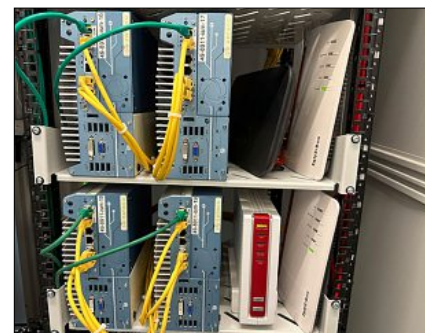
Die Fritz!Box im Rechenzentrum (rechts) als Router für den Test-Datenverkehr.
