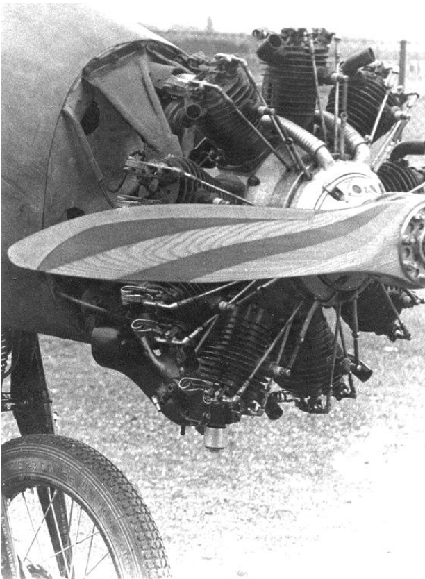
Einbau des Salmson 9 Ad - Sternmotors in die A/3-Zelle.
