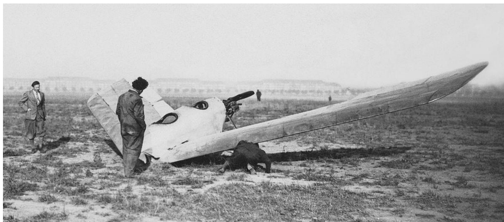
Im August 1929 brach während eines Startversuchs auf einer abgelegenen Ecke des Flugplatzes Tempelhof das Bugrad der LF 5 weg. Dem Einflieger Gottlob Espenlaub passierte zum Glück nichts, aber die Schäden an der Zelle waren doch erheblich.
