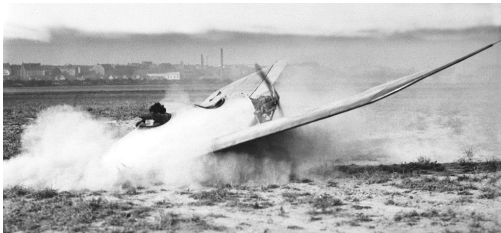
Im August 1929 brach während eines Startversuchs auf einer abgelegenen Ecke des Flugplatzes Tempelhof das Bugrad der LF 5 weg. Dem Einflieger Gottlob Espenlaub passierte zum Glück nichts, aber die Schäden an der Zelle waren doch erheblich.
