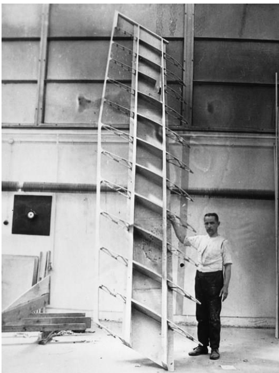
Die Soldenhoff LF 5 im Bau: Zwei Ansichten des noch weitgehend unbepflankten Flügels, die einen guten Einblick in die Konstruktion des Tragwerks erlauben.
