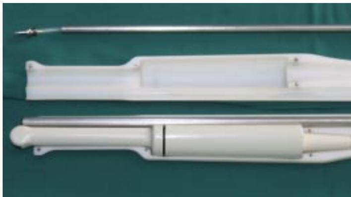
Figura 3- O transdutor R10 convexo (Esaote/Pie Medical, Maastricht, the Netherlands) em um sistema delineado para a guia de probe (Nutricell, Campinas, Brazil).
