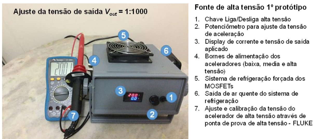
Figura 16 - Primeiro protótipo da fonte de alta tensão projetada e construída e sua calibração utilizando ponta de prova comercial FLUKE
