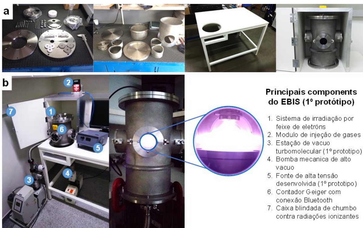
Figura 11 - Primeiro protótipo desenvolvido do sistema de irradiação por feixe de elétrons mostrando (a) a fabricação de todas as peças que compõem o sistema de irradiação e (b) montagem do primeiro protótipo e o primeiro feixe de elétrons obtido
