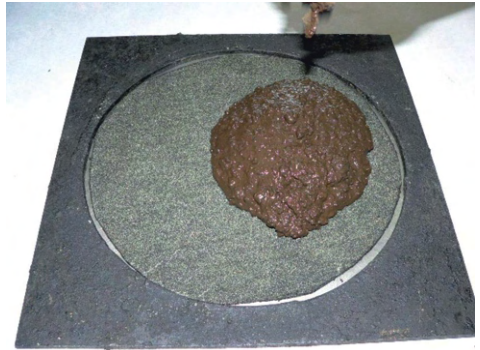
Photograph 17: Pour the slurry mix on the felt
