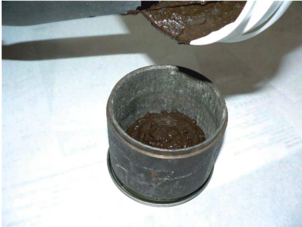
Photograph 12: Pour slurry in mould
