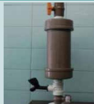
**Nota 5:** A eficiência do leito filtrante de zeólita utilizado nessa modalidade de tratamento, como barreira de remoção, e a significativa dosagem de cloro ativo no vaso filtrante têm assegurado resultados bacteriológicos com ausência de *E. coli*.
