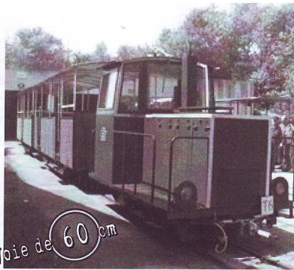
▲ Locotracteur construit sur les bases d'un vieux CACL des Ardoisières d'Angers. Photo Eric Sauvage.
