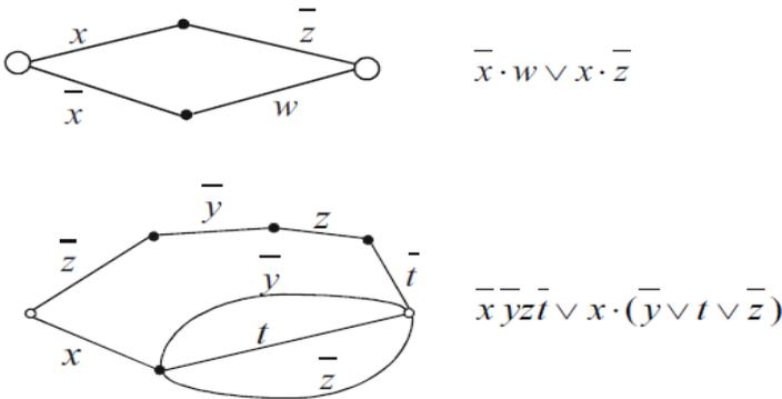
**Определение.** Ребра схемы, помеченные символами переменных или их отрицаний, называются *контактами*. Контакт называется *замыкающим*, если он помечен символом переменной, и *размыкающим*, если он помечен символом отрицания переменной.
