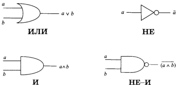
Соединяя функциональные элементы вместе, получаем функциональную схему. Пример такой схемы приведен на рисунке 1. С ее помощью можно реализовать любую булеву функцию.
