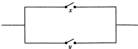
Ясно, что эта схема проводит электрический ток в том и только в том случае, когда по меньшей мере один из контактов ( $x$  или  $y$ ) замкнут, т.е. лишь в случае, когда хотя бы одна из булевых переменных ( $x$  или  $y$ ) принимает значение 1. Булева функция от двух
