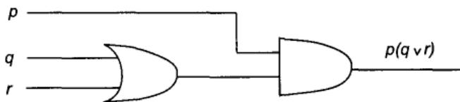
Данная схема построена для функции  $p(q \vee r)$ , полученной путем минимизации функции в предыдущем примере с использованием карты Карно.
