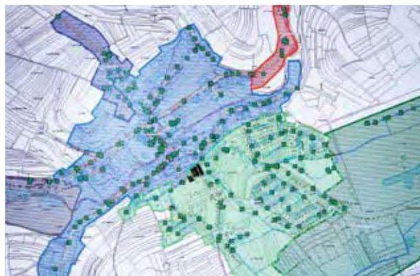
*Die Trinkwasserversorgung der Ortschaft erfolgt mittels der Wasserbehälter auf „Wobierg“ (blau eingefärbtes Gebiet) und „Laaschert“ (grün). Zur Versorgung höher gelegener Gebiete (dunkelblau bzw. rot eingefärbt) wird eine Pumpe zugeschaltet. Das Wasser des „Neumann“-Brunnens dient gegenwärtig ausschließlich zur Versorgung einiger weniger Haushalte rund um die „Neumann“-Mühle (rot), speist, falls notwendig, aber auch den Behälter „Wobierg“*
