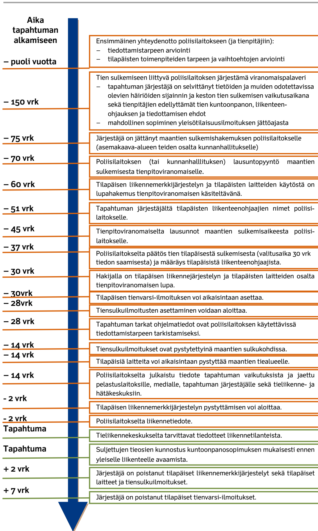
Kuva 4. Tapahtuman edellyttämien tilapäisten toimenpiteiden lupaprosessin ja toteutuksen aikataulu tapahtumassa, jossa tie tilapäisesti suljetaan henkilöautojen tai moottoripyörien nopeuskilpailun vuoksi.
