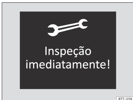
Fig. 1 Representação esquemática: exemplo de indicação no display do instrumento combinado para um evento de serviço vencido.
