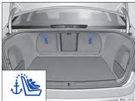
Fig. 9 Cintos de fixação superiores encaixados no compartimento de bagagem.
