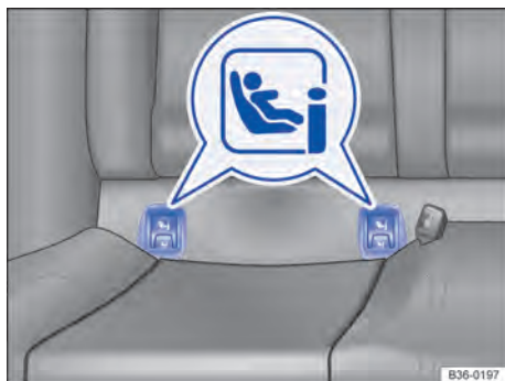
Fig. 6 No banco do veículo: identificação dos pontos de ancoragem ISOFIX para cadeiras de criança.
