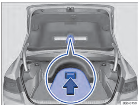
Fig. 18 Na tampa do compartimento de bagagem: suporte para o triângulo de segurança.
