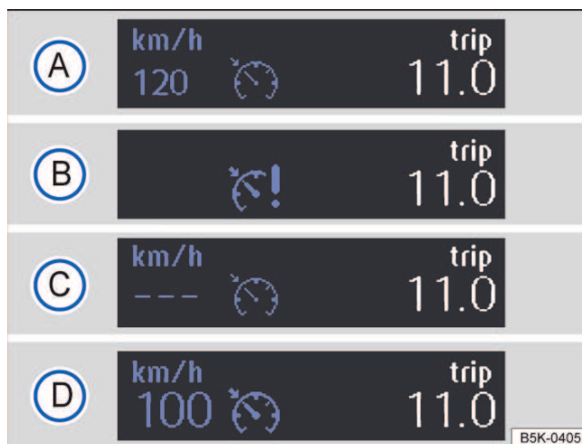
Fig. 102 No display do instrumento combinado: indicadores de status do GRA (representação esquemática).
