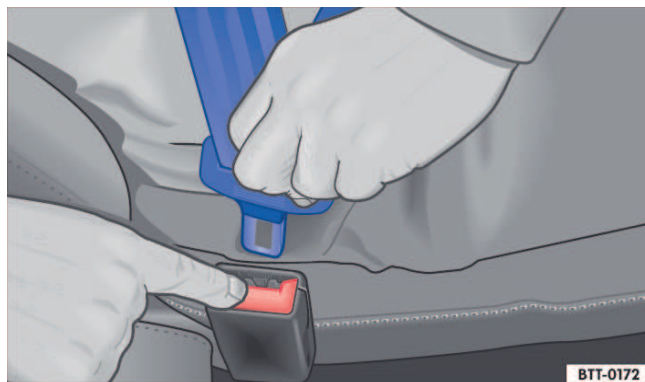
Fig. 32 Soltar a lingueta do cinto de segurança do fecho do cinto de segurança.
