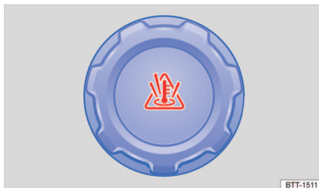
Fig. 154 No compartimento do motor: tampa do reservatório de expansão do líquido de arrefecimento do motor.
