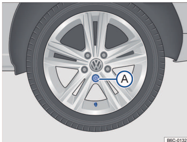
Fig. 169 Troca de roda: sequência de remoção dos parafusos da roda.
