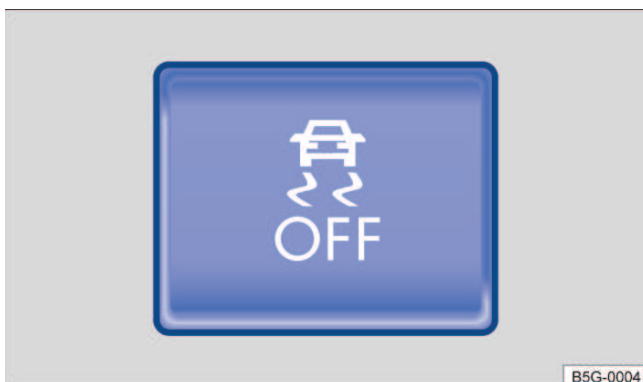
Fig. 107 No controle central: botão para desligar e ligar o ASR manualmente (para veículos com ESC).
