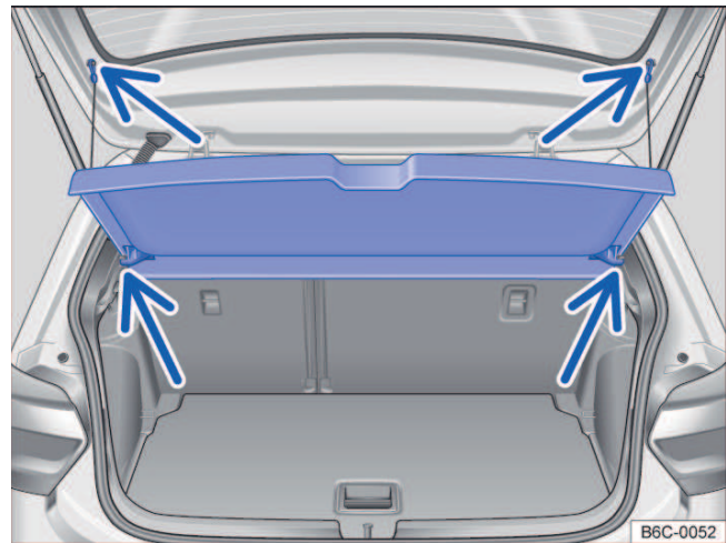
Fig. 116 No compartimento de bagagem: remover e instalar a cobertura do compartimento de bagagem.
