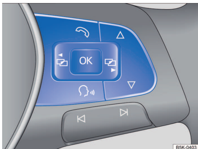
Fig. 22 Lado direito do volante multifunções: botões para comando dos menus e exibições de informação do instrumento combinado.
