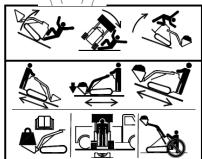
**AVERTISSEMENT**: La conduite sur des pentes ou avec une charge surélevée peut entraîner le basculement de la machine. Risque de blessures graves ou mortelles par écrasement.
