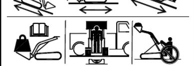
切勿超出额定负载能力。在紧实平整的地面上装载。负载升起时不得离开平台。
