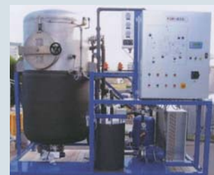
減圧蒸留装置
