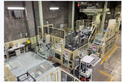
縦型高速双ロール铸造実験機 (R&Dセンター：名古屋)
