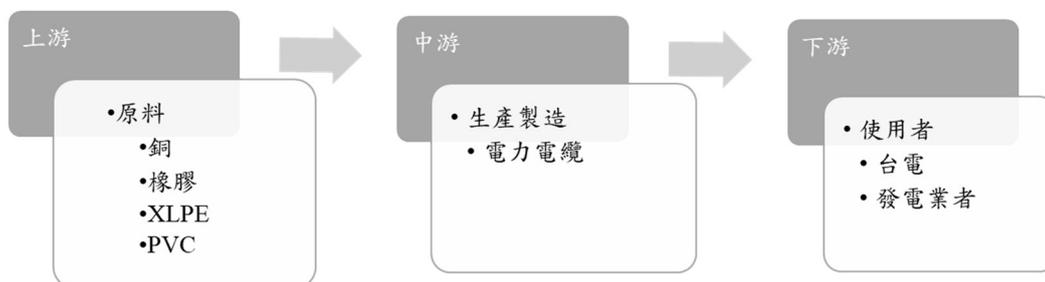
我國電力電纜業產業發展成熟，主要為重資本行業，上游提供製造電力電纜等產品的原材料，主要分為導體、絕緣體及被覆體等，導體主要有銅、鋁等，又以銅為大宗，約占總原料成本50%以上；絕緣體主要分為橡膠、聚乙烯(PE)及聚氯乙烯(PVC)等化工材料為主，經化學鍵交連後之交連聚乙烯(XLPE)，因絕緣佳、耐熱性佳且故障率低等，為目前主要輸配電線路使用之電力電纜；被覆體則多以橡膠及聚氯乙烯(PVC)等化工材料為主。中游生產製造，從導體加工開始，在導體外圍一層層的加上絕緣體及被覆體等，而電線電纜生產難度在於無法透過重新組裝更換缺失，而是層層相扣，因此對生產流程及設備有較大的要求。
