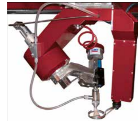
5 axis 3D Evolution ±69° interpolating system with ±300° or infinite (optional) rotation Sistema Evolution 3D a 5 assi interpolanti ±69° con rotazione ±300° o infinita (opzionale)
