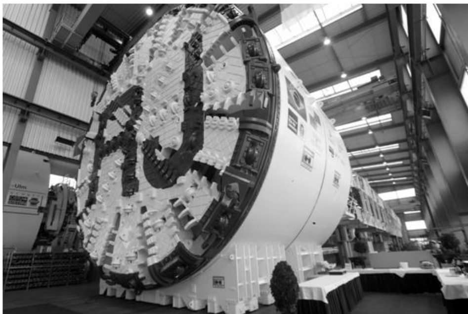
Figura 24: TBM – Tunnel Boring Machine , utilizado nos trechos de maior densidade demográfica da Linha 4 do Metrô do Rio de Janeiro. Fonte: RAILWAY GAZETTE (2015).
