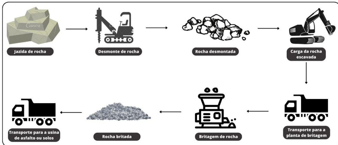
Figura 3-4 – Esquema de obtenção de agregados graúdos virgens para pavimentação. Fonte: adaptado de (VEGA ARAUJO et al. , 2020).
